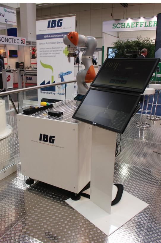
Der Benutzer wird durch eine 3D-Kamera erkannt und am System angemeldet, anschließend kann er sich mit dem Roboter unterhalten. (Bild: IBG)
