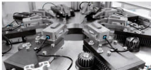
oder Metallbauteilen viele Parameter auf, die das Handling deutlich erschweren. Mit einer speziell entwickelten Prozesstechnik ist es IBG gelungen, die Montage der weichen Bestandteile einer Luftfederung im Automotive-Bereich zu automatisieren.
