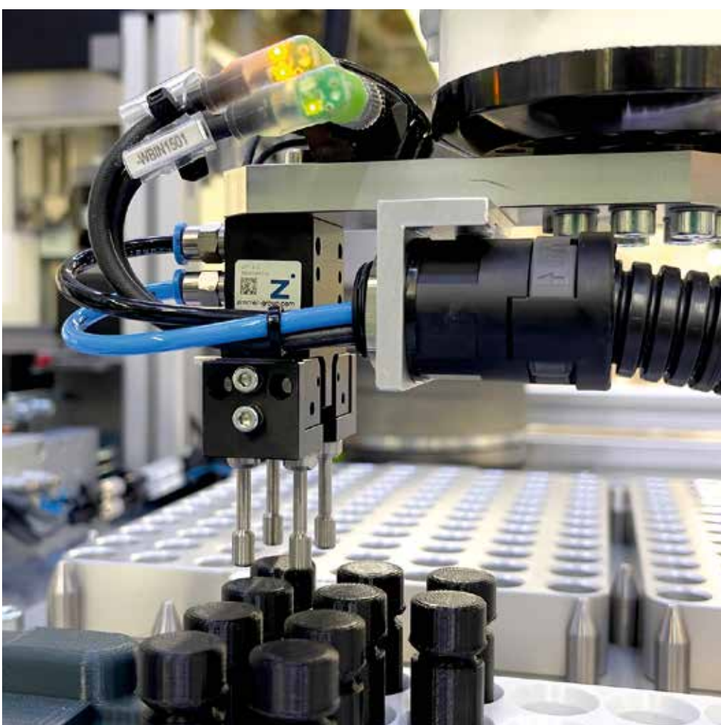
Handling von kleinen Glasflaschen: IBG setzt einen sensiblen Prozess zur Probenentnahme im Laborumfeld durch spezielle Produktionsmodule um. Handling of small glass bottles: IBG realises a sensitive process for taking samples in the laboratory environment using special production modules.
