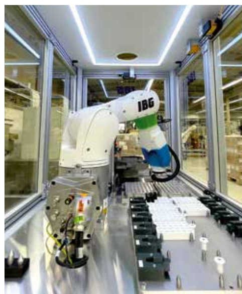
Handling von kleinen Glasflaschen: IBG setzt einen sensiblen Prozess zur Probenentnahme im Laborumfeld durch spezielle Produktionsmodule um. Handling of small glass bottles: IBG realises a sensitive process for taking samples in the laboratory environment using special production modules.
