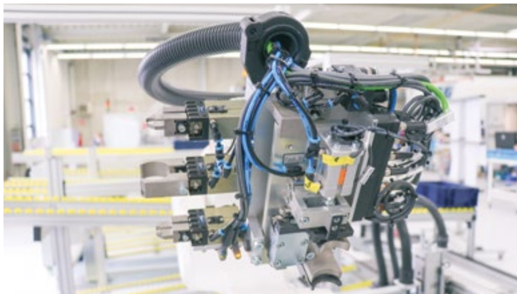
Bauteilspezifischer Robotergriffe zur Montage | Component specific robot gripper for assembly
