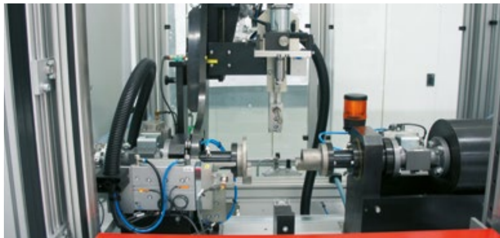
Halbautomatischer Gasdruckreglerprüfstand für Mitteldruck-Geräte | Semi-automatic gas pressure regulator test stand for medium pressure devices
