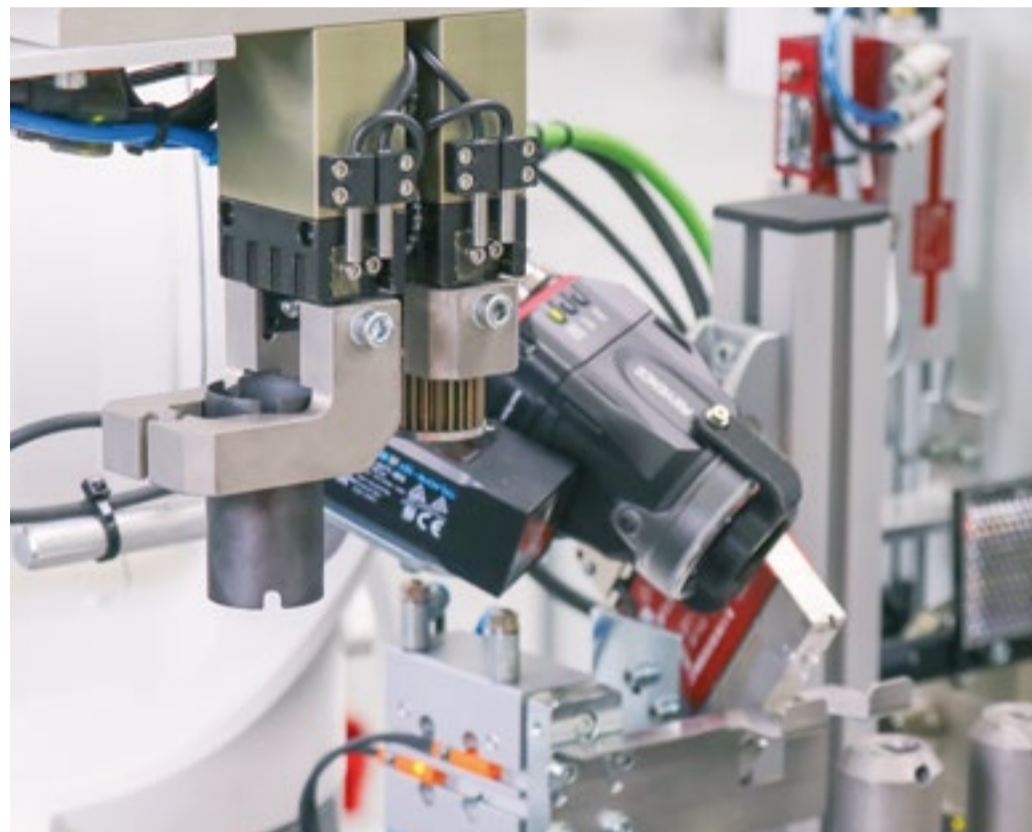
Industrielles Bildverarbeitungssystem zur Teileanwesenheitsprüfung | Industrial vision system for parts presence control
