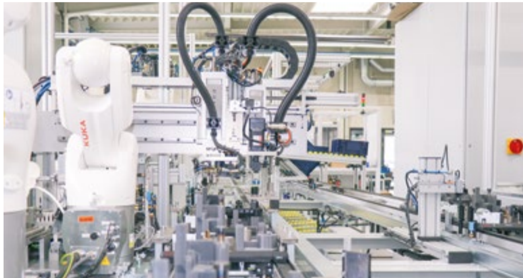
Transfersystem mit angepasstem Werkstückträger | Transfer system with adapted workpiece carrier
